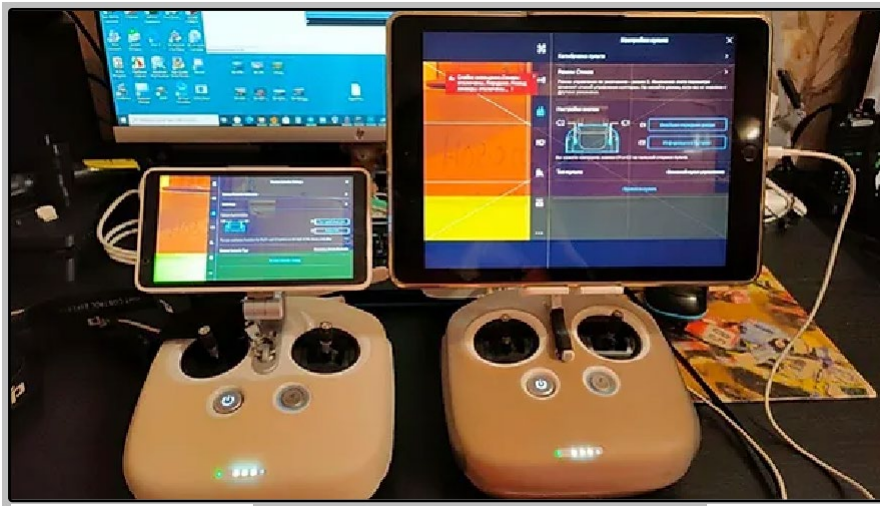
Связка : GL300L с iPad (первичный) и GL300K (вторичный) подключены к Phantom 4 Pro V2.0
