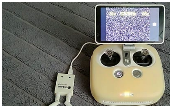
Вывод картинки с совместимого UVC-устройства (в данном примере это приемник 5.8G FPV видео сигнала)
