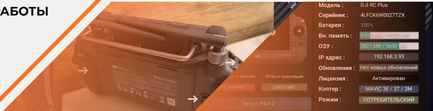
Нажимаем на кнопку “ДРОНЫ” и выбираем дрон, с которым будет работать пульт
